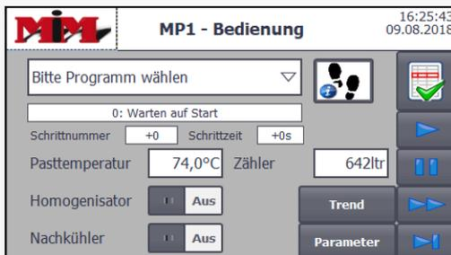
**Pasteurisierungsprogramm**: das gewünschte Programm kann durch antippen der entsprechenden Tasten ausgewählt werden.
