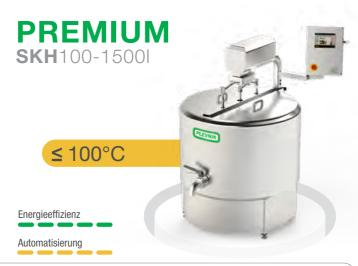
Professioneller, autonomer und effizienter Käsekessel für erfahrene Benutzer. Ermöglicht ein schnelleres Erhitzen – verfügt über ein geschlossenes Drucksystem (höhere Temperaturen) und indirekte Kühlung. Schneidet die Käsemasse automatisch (automatische Harfen). Der Kessel steht auf einem stabilen Untergestell mit Kippmechanismus. Inox-Abdeckung zum Schutz des Motors.
