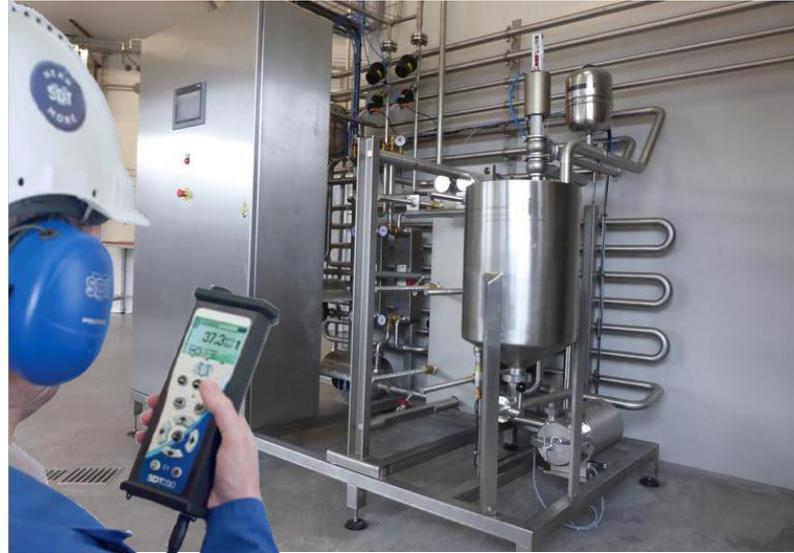
NEU mobiles kalibrieren von Temperaturfühlern bis zur Steuerung und Anzeige
